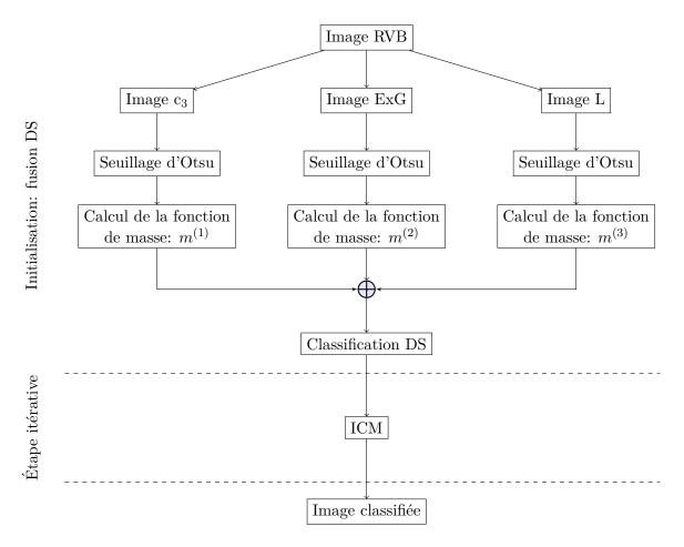
Figure 2: Schéma pour détecter simultanément les zones d'ombre et de végétation.
